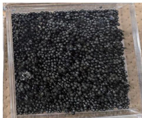
図2 マイクロ波加熱後のセルロース粒
