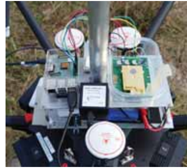
図 2. ドローンに搭載されたセンサー類およびロガー (Raspberry Pi), バッテリー. パイプの右側が CO 2 センサー.
