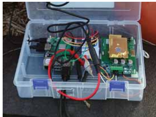
図 2 鉄塔に設置された CO 2 観測装置。向かって右側が CO 2 センサー、左側がロガー代わりのラズベリーパイ。
