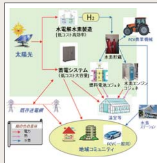
再エネ電力を農村や地域コミュニティで有効利用するためのエネルギーシステム概念図 Conceptual diagram of an energy storage system for effective use of renewable energy in rural areas and local communities
