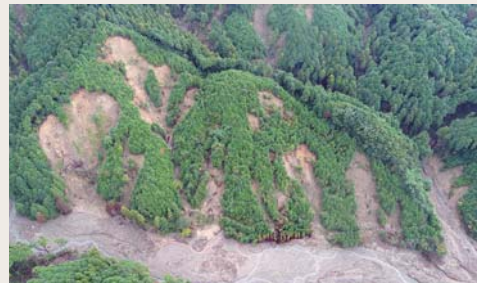
山地の地質・地形・土層・地下水・植生の全てが関連して発生する斜面崩壊現象の例(2017年九州北部災害) Landslides in hillslopes at northern Kyushu in 2017
